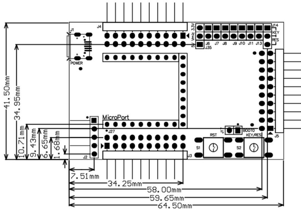
图 1.15 AM217-Core 开发板机械尺寸
