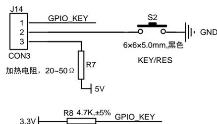
图 1.8 加热电路和按键电路
