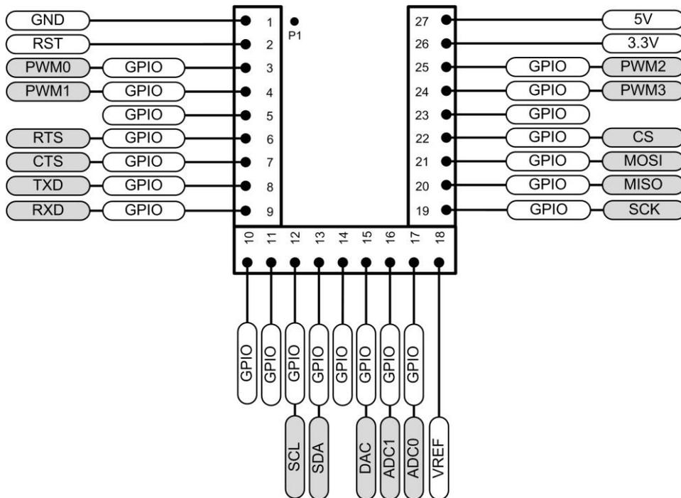
图 1.12 MicroPort 引脚分配示意图
