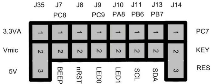
图 1.10 板载外设接口引脚图示
