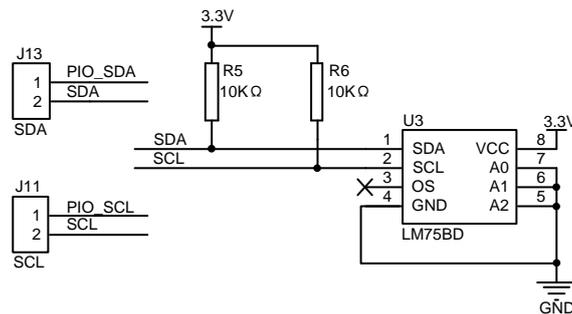
图 1.9 LM75B 电路
