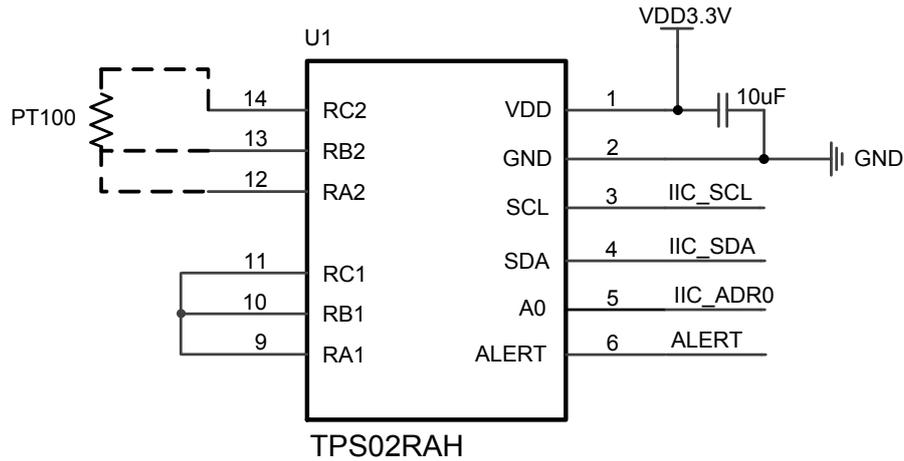
图 3 TPS02RAH 采集通道二温度典型电路
