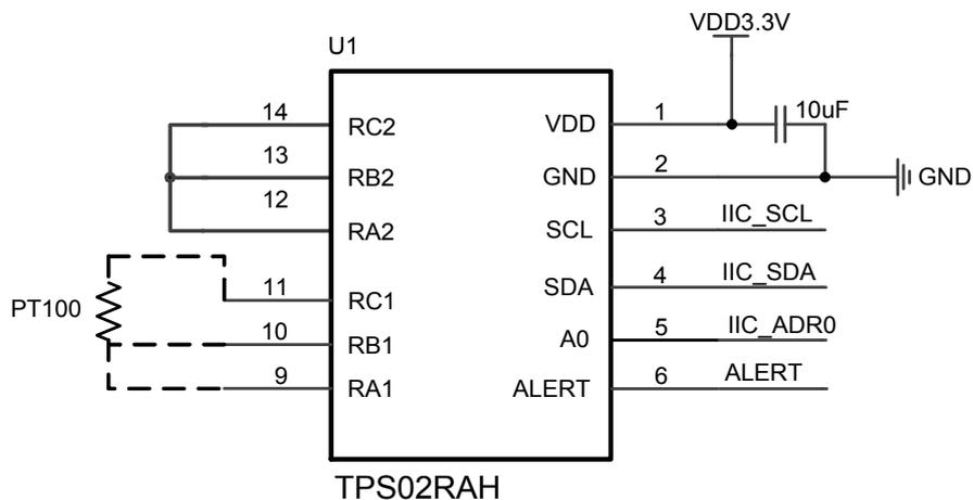
图 2 TPS02RAH 采集通道一温度典型电路
