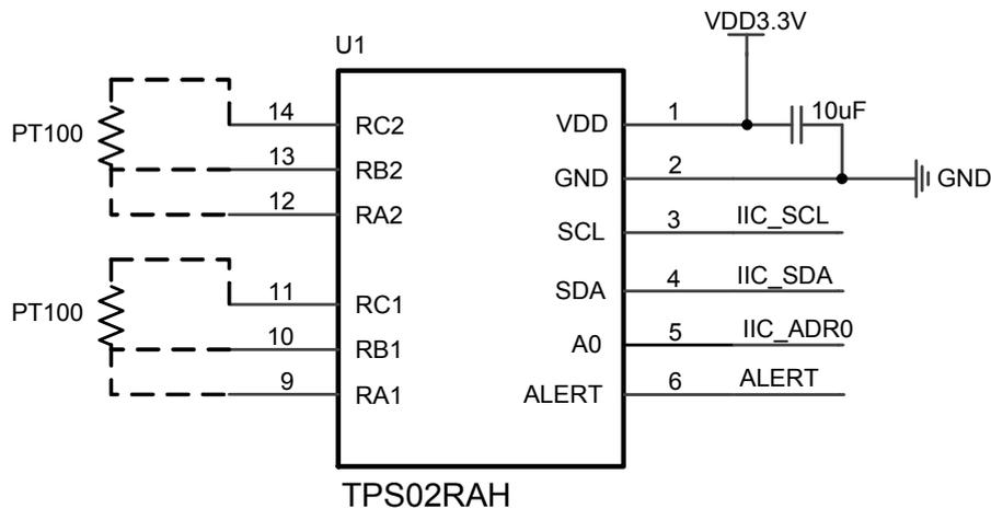
图 1 TPS02RAH 双路温度采集典型电路
