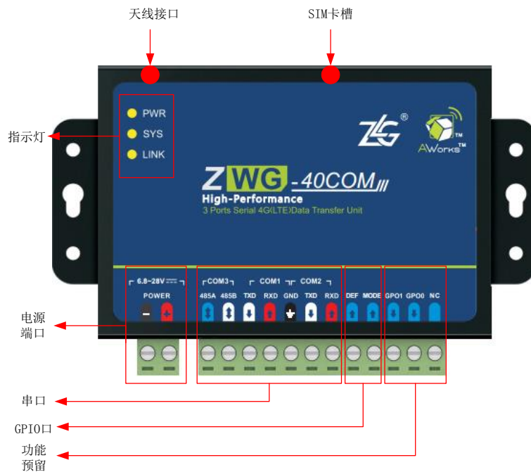
图 2.1 ZWG-40COM 接口排列示意图
