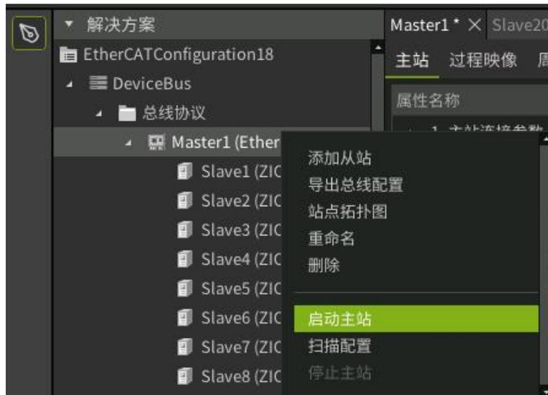
10) AWStudio 可以实时读取数字输入模组的值。在 AWStudio 中，双击 master 主站节点打开主站配置界面，在“过程映像”界面中可以看到当前 EtherCAT 网络的过程映像数据结构和实时值。对于 ZIOB-E1600DN 模组，用电线分别连接分线底板“1”号插座的 17 脚 GND 和 1~16 任意一个信号脚，AWStudio 过程映像的对应的位将显示为 1，否则显示为 0；对于 ZIOB-E1600DP 模组，用电线分别连接分线底板“1”号插座的 18 脚 24V 和 1~16 任意一个信号脚，AWStudio 过程映像的对应的位将显示为 1，否则显示为 0。
