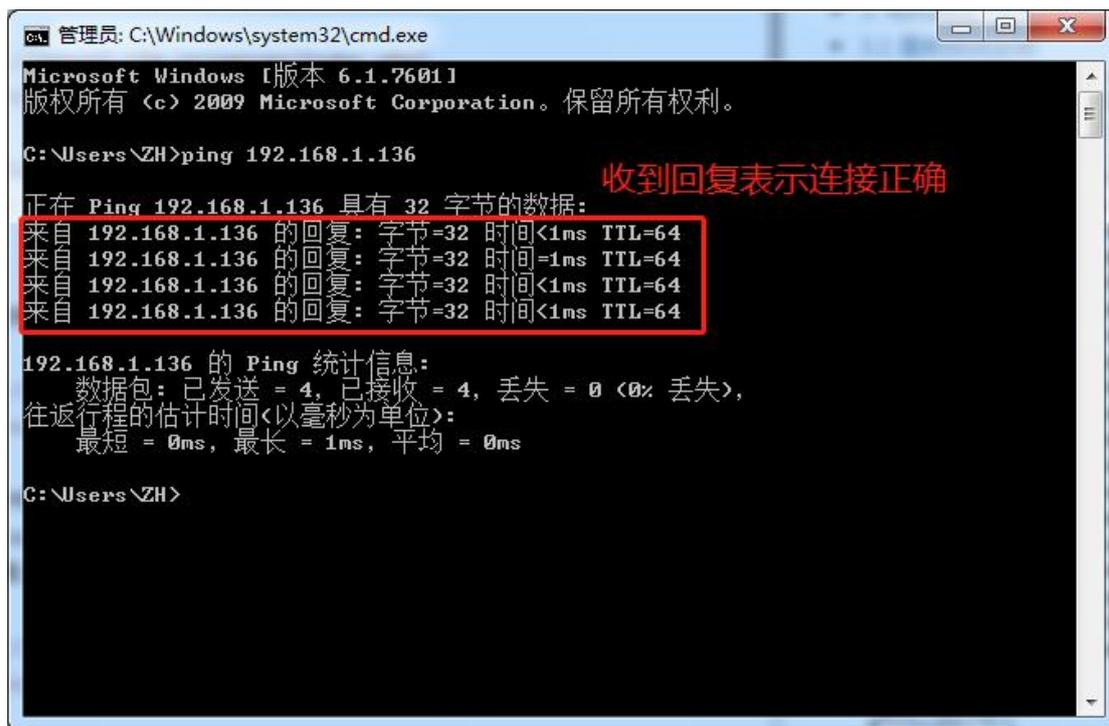
6) 启动主站。AWStudio 需要控制器启动 EtherCAT 主站才能正常使用。打开“开发资料包/tools/常用辅助工具/winscp553setup.exe”工具，输入 IP: 192.168.1.136，用户名: root，密码: root，点击登录。
